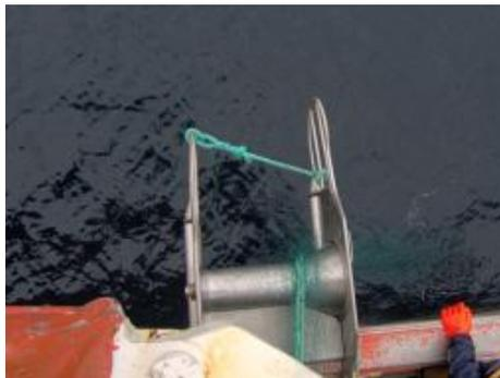
Guide permettant de remonter un filet maillant sur le navire par les côtés
