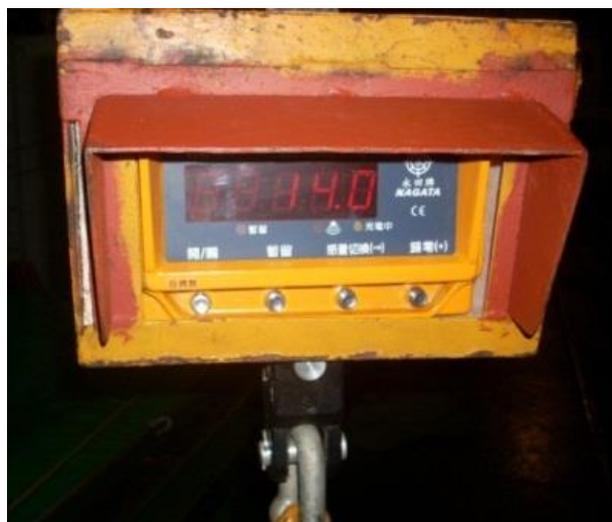
**Figure 40 :** Balance à crochet.
