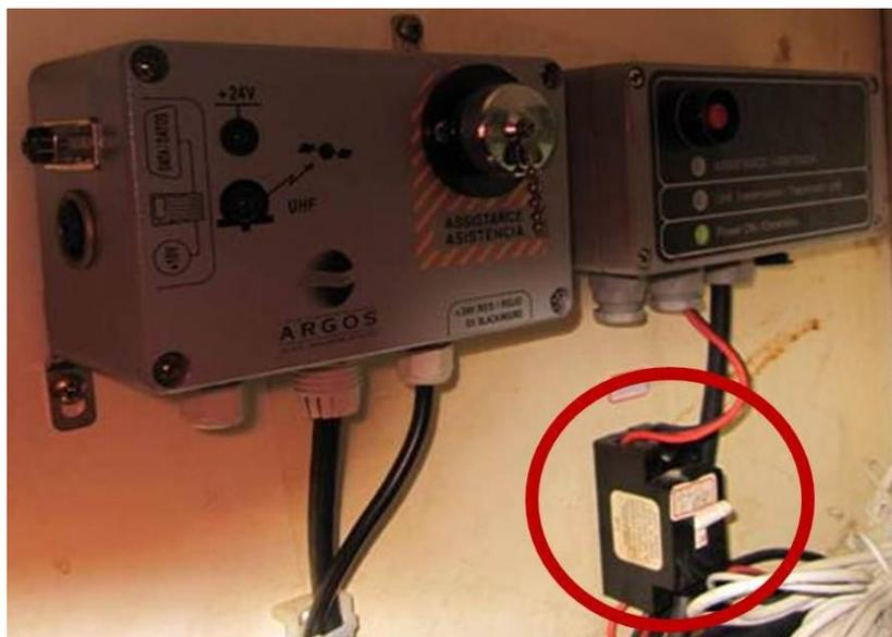
**Figure 29 :** Boîtier de raccordement Argos avec interrupteur marche/arrêt.
