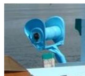
**Figure 18 :** Rouleau utilisé sur les thoniers à filets maillants.
