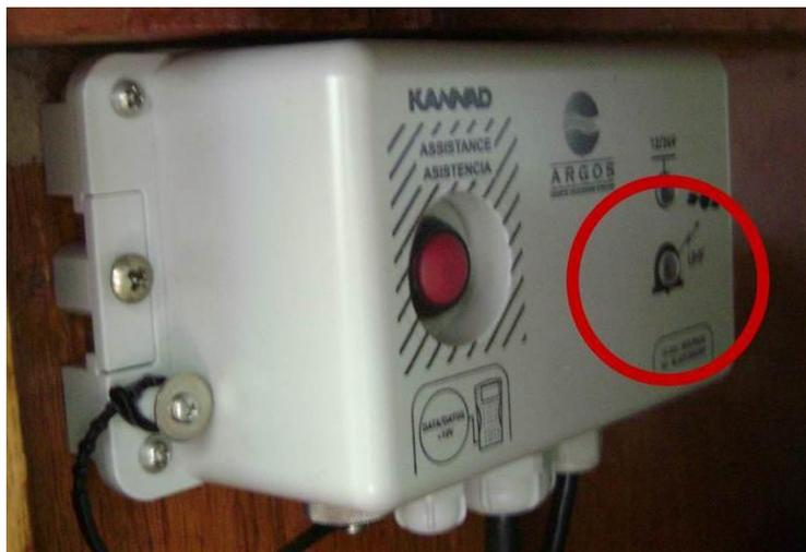
**Figure 30 : Boîtier de raccordement Argos éteint**
