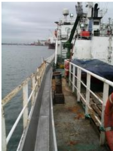
Glissière (ou canal) utilisée pour guider le filet de l'emplacement de virage à l'arrière du navire ou il sera rangé, prêt à être de nouveau déployé
