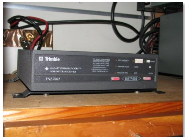
Figure 24 : Unité et antenne Trimble Galaxy.
