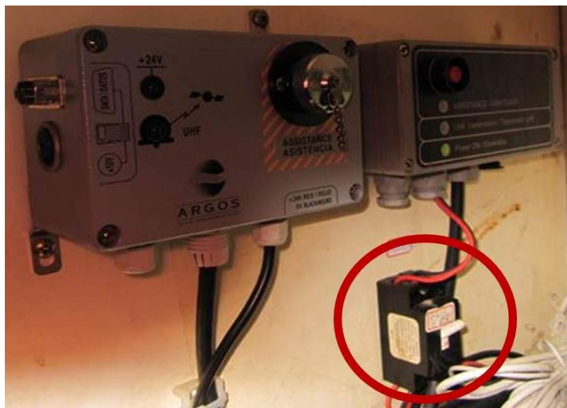
Figure 29 : Boîtier de raccordement Argos avec interrupteur marche/arrêt.
