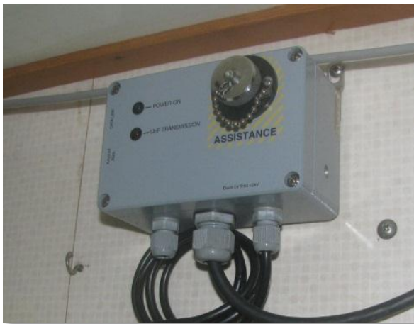
Figure 26 : Boîtier de raccordement de l'appareil Argos MAR GE et boîtier de raccordement d'un appareil MARGE V2.
