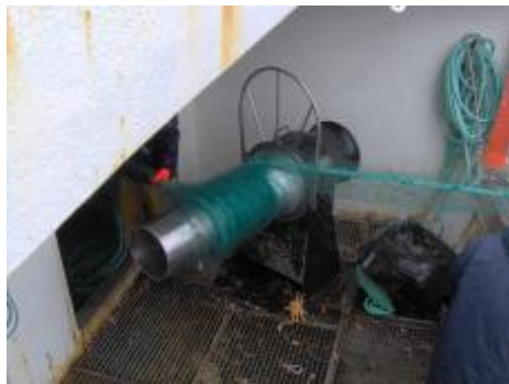
Tambour ou enrouleur de filet utilisé pour haler le filet maillant
