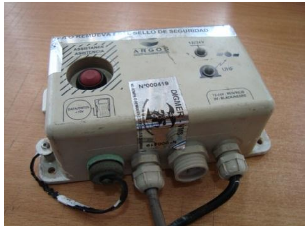
Figure 26 : Boîtier de raccordement de l'appareil Argos MAR GE et boîtier de raccordement d'un appareil MARGE V2.
