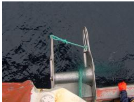
Guide permettant de remonter un filet maillant sur le navire par les côtés
