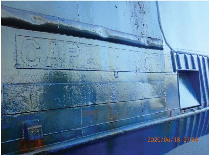
Figure 3 : Nom précédent « CAPE WRATH II » soudé sur la coque.
