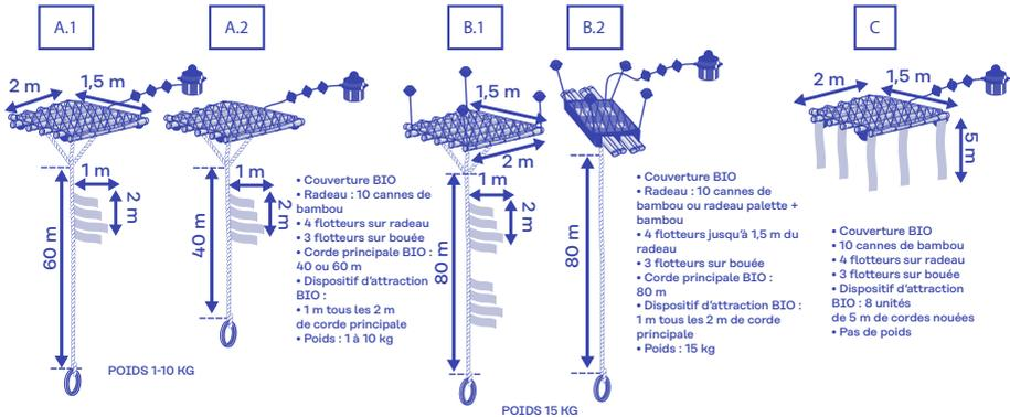
*Résumé des dimensions et matériaux des prototypes sélectionnés pour le projet BIO-FAD.*
