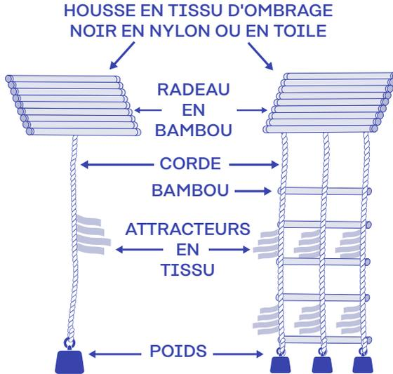
1. La structure de surface du DCP ne doit pas être couverte, ou couverte uniquement de matériau sans mailles.
