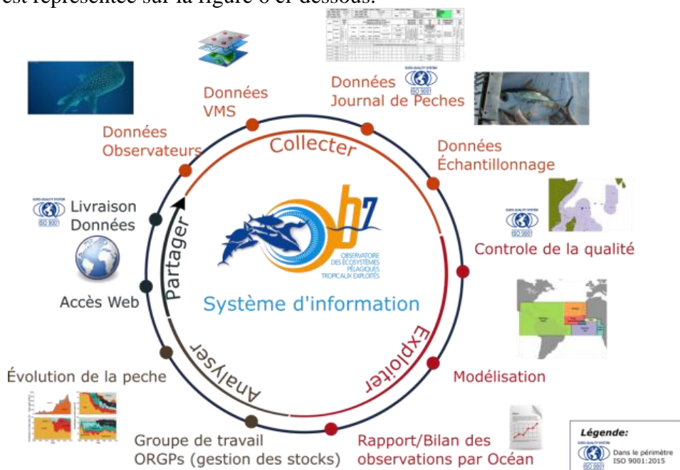
Figure 6. Schématisation du système d'information mis en place à l'IRD pour la gestion des données de la pêche thonière tropicale à la senne de leur collecte jusqu'à leur traitement et restitution.
