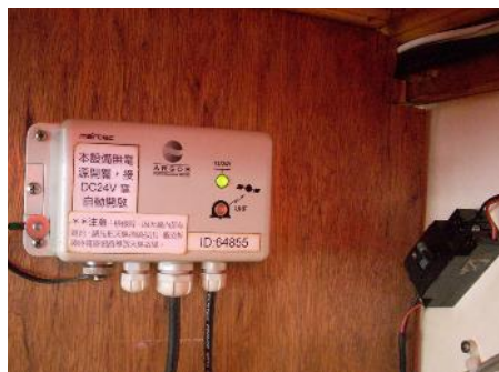
Figure 66: Boîtier de raccordement Argos avec interrupteur marche/arrêt
