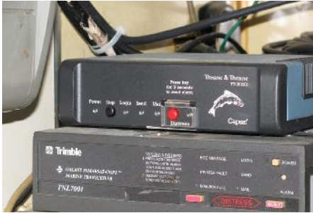
Figure 63: Deux unités de SSN installées à bord d'un palangrier thonier (Thrane & Thrane 3022D INMARSAT et boîtier de raccordement de l'unité Trimble Galaxy)
