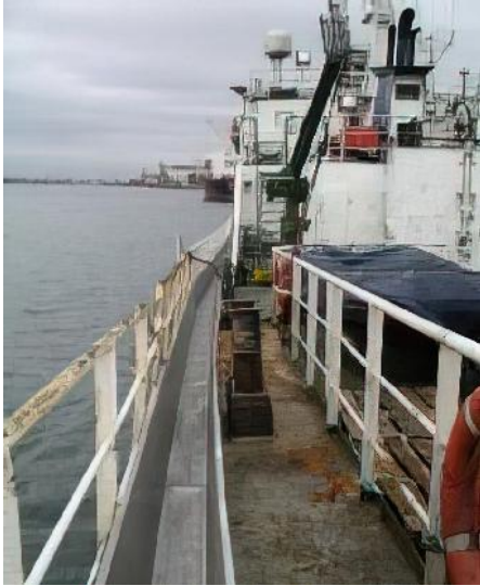
Glissière (ou canal) utilisée pour guider le filet de l'emplacement de virage à l'arrière du navire ou il sera rangé, prêt à être de nouveau déployé
