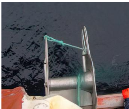
Guide permettant de remonter un filet maillant sur le navire par les côtés
