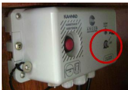
Figure 84: Boîtier de raccordement Argos éteint
