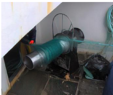
Tambour ou enrouleur de filet utilisé pour haler le filet maillant
