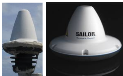
Figure 46: Unité et antenne Thrane & Thrane (Sailor) Capsat TT-3022D
