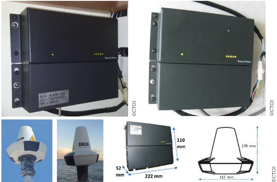
Figure 57: Unité et antenne du terminal Thrane & Thrane (Sailor) Capsat 6194
