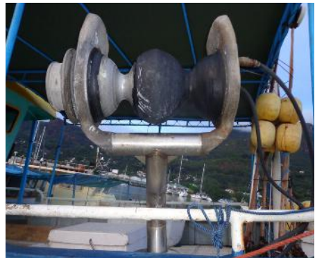
Figure 38: Rouleau/guide utilisé sur les thoniers utilisant le filet maillant
