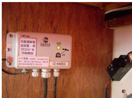
Figure 66: Boîtier de raccordement Argos avec interrupteur marche/arrêt
