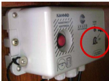
Figure 67: Boîtier de raccordement Argos éteint
