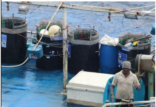
**[Fig 9]** Guide-ligne sur le rail &et dispositif de remontée de l'engin automatique derrière le membre d'équipage. Barils de palangre le long du rail côté bâbord.
