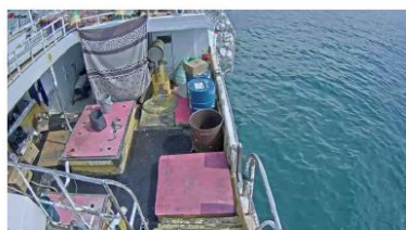
Figure 2. Équipement de SE à 3 caméras installé sur une palangre couvrant les principales zones des opérations de pêche et de manipulation du poisson. Vue des 3 caméras : (gauche) Caméra arrière - filage de la palangre fournissant des informations sur les hameçons, les flotteurs, les techniques d'atténuation et les appâts ; (milieu) Pont de pêche 1 - informations sur le halage, les captures et les rejets, l'identification des espèces, la taille et le devenir ; et (droite) Pont de pêche 2 - devenir de l'espèce, taille, identification des espèces (source : Digital Observer Services).
