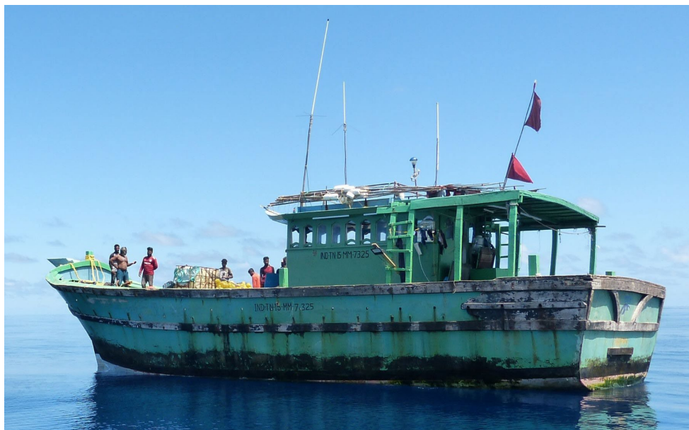
[Fig.13] Bâbord Bouées sur le toit de la timonerie mais flotteurs sur le pont. Notez la lumière de pêche fixée sur l'échelle de la timonerie
