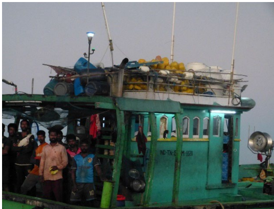
[Fig.16] Toit de la timonerie avec bouées et flotteurs arrimés
