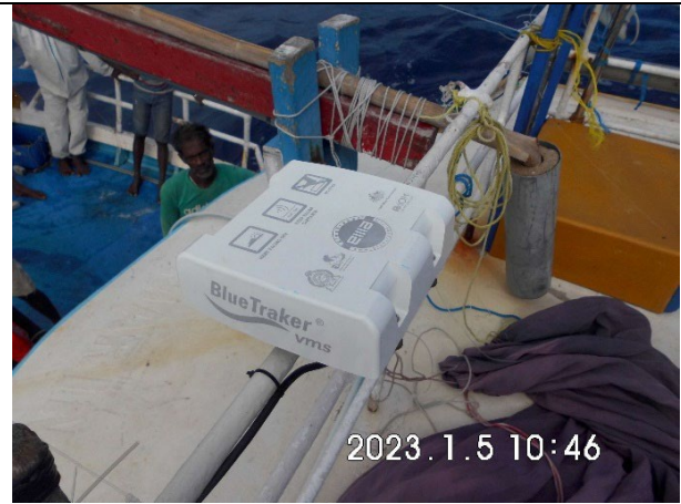
Fig 24. Antenne de SSN sur le toit
