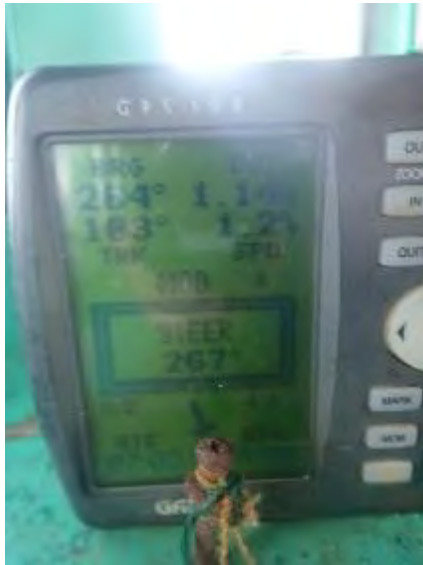
[Fig.11] Position et distance jusqu'à la fin de ligne
