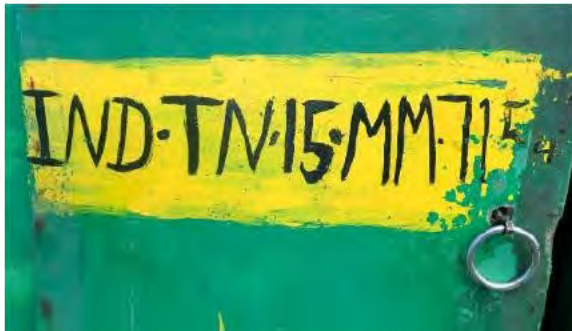
[Fig.7] Porte du pont. Marquage de l'immatriculation déficient
