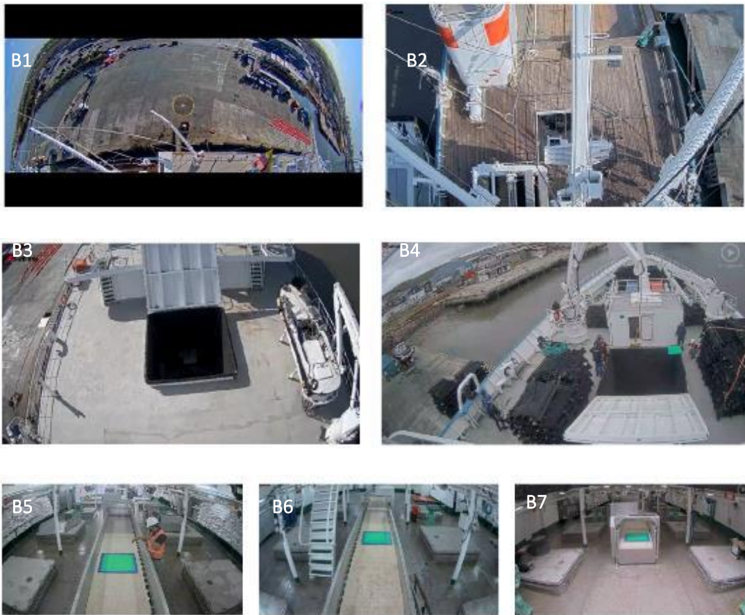
Figure 1. (A) Exemple d'un système de SE à 6 caméras installé dans un senneur couvrant les principales zones de la pêche et des opérations de manipulation du poisson (tiré de Murua et al., 2020b) et (B) Système de SE à 7 caméras (4 sur le pont supérieur et 3 sur le pont de coffre) installé dans un senneur, couvrant les zones principales des opérations de pêche et de manipulation du poisson, y compris 1 caméra supplémentaire sur le tapis roulant : (B1) Caméra de vue panoramique 360° (par exemple, vue du côté bâbord), (B2) Caméra de vue de la poupe de la vigie, (B3) Caméra de vue de la grue du pont de travail, (B4) Caméra de vue du pont avant, (B5) Caméra de vue de la poupe du tapis roulant, (B6) Caméra du milieu du tapis roulant, et (B7) Caméra de la proue du tapis roulant (source : Digital Observer Services).
