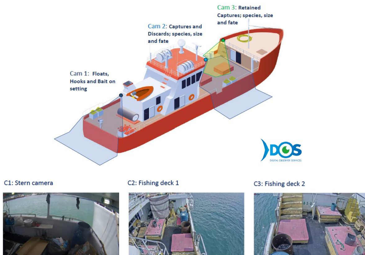
Figure 2. Exemple d'un équipement de SE à 3 caméras installé sur une palangre couvrant les principales zones des opérations de pêche et de manipulation du poisson. Vue des 3 caméras : (gauche) Caméra arrière - filage de la palangre fournissant des informations sur les hameçons, les flotteurs, les techniques d'atténuation et les appâts ; (milieu) Pont de pêche 1 - informations sur le halage, les captures et les rejets, l'identification des espèces, la taille et le devenir ; et (droite) Pont de pêche 2 - devenir de l'espèce, taille, identification des espèces (source : Digital Observer Services).
