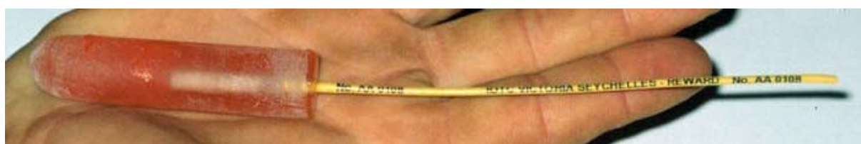
Photo b : fausse marque archive en résine polyester aux dimensions identiques des marques archives type XXX. Ajout d'une marque conventionnelle insérée et collée à la colle époxy-uréthane.
