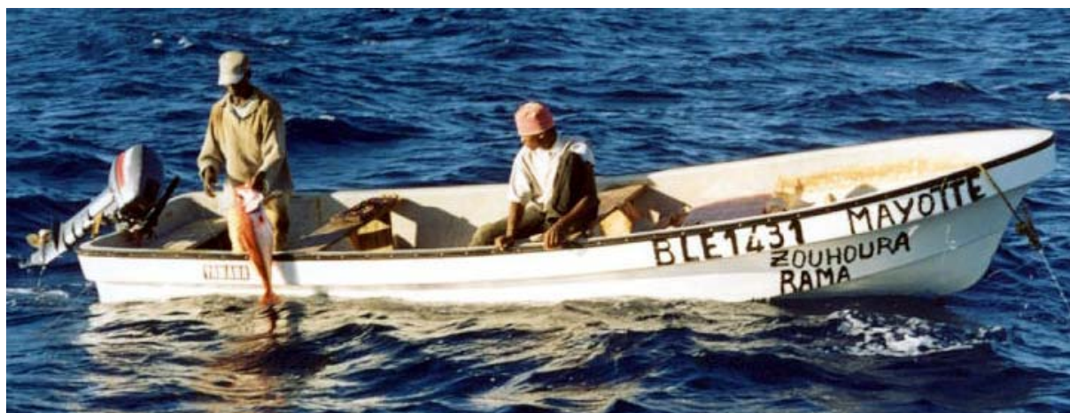
Photo d : embarcation typique des pêcheurs sur DCP à Mayotte, barque polyester de 7 m de marque « Yamaha », motorisation hors bord de 25 chevaux.
