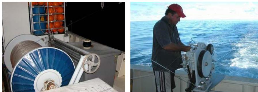
*Photo 1 et 2. (gauche) Treuil hydraulique Lindgren Pitman contenant la ligne mère, (droite) lanceur de ligne de même marque utilisé sans puissance pour le filage de la ligne mère.*
